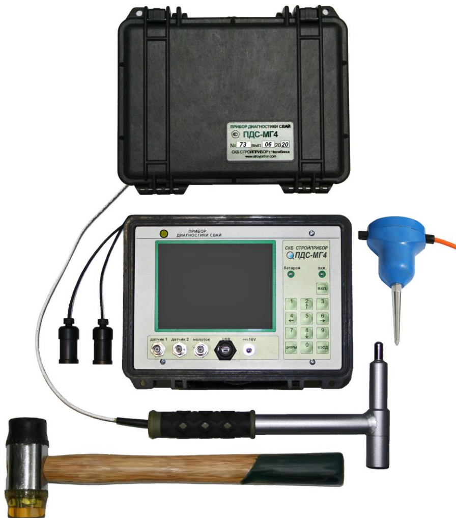
Рисунок 1 – Общий вид прибора диагностики свай ПДС-МГ4
